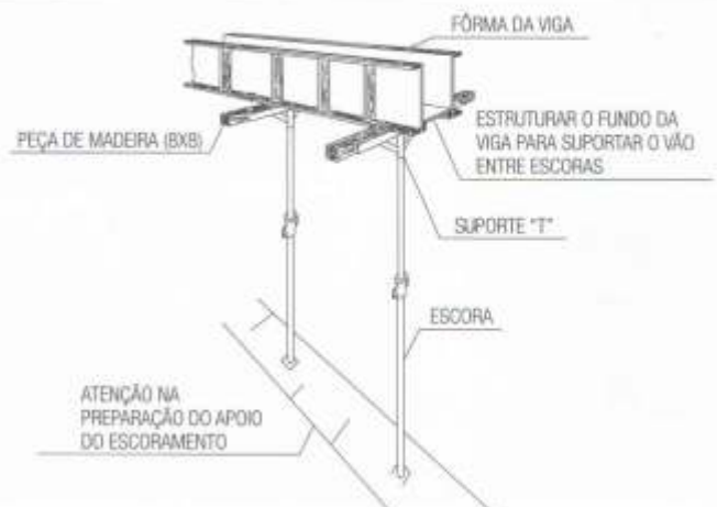
Detalhe da montagem das escoras nas vigas
